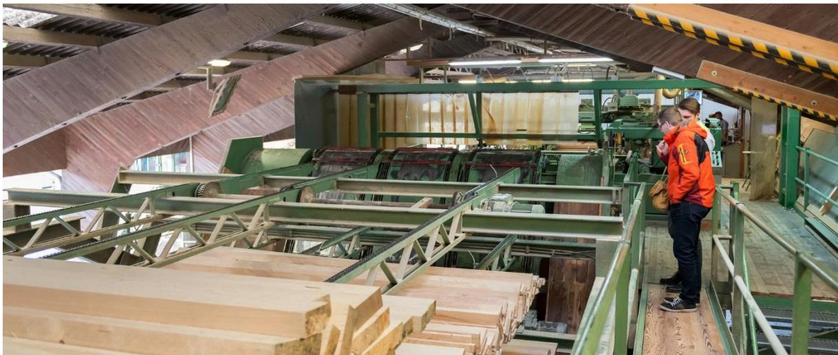
Danach wird das sogenannte Rundholz zu Schnittholz verarbeitet. Diese Arbeit übernehmen in der Regel Gatter- und Bandsägen. Das Hauptprodukt eines jeden Sägewerks ist also Schnittholz. Nun ist es so, dass aus einer Fichte mit 4 Tonnen nicht 4 Tonnen Schnittholz entstehen. Bei der Verarbeitung von Holz in Sägewerken fallen sogenannte Sägenebenprodukte an – vor allem Hackschnitzel und Sägespäne. Ganze 40 Prozent des Holzeinschnitts sind Sägenebenprodukte, während 60 Prozent Schnittholz sind.
